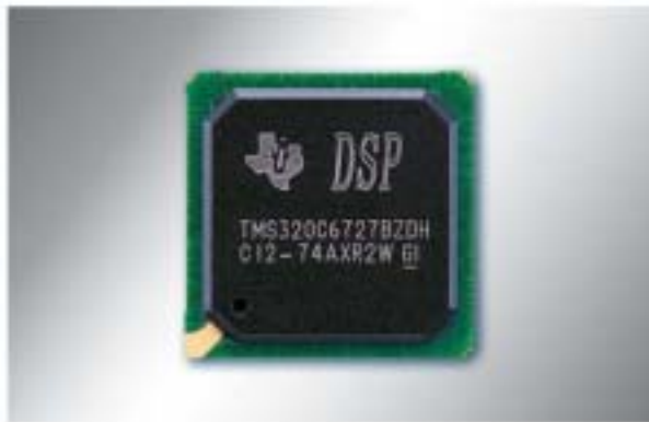
TX/RX DSP IC (250 MHz clock)
